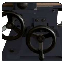
Dubbele draaibank in laterale en lengterichting op zwaluwstaart
