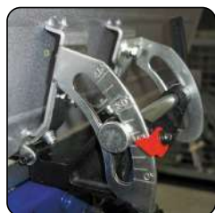
Geleider van geprofileerd aluminium profiel hellend tot 45°
