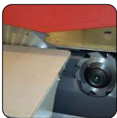
Zaagblad \varnothing 250 mm en voorritsblad \varnothing 80 mm
