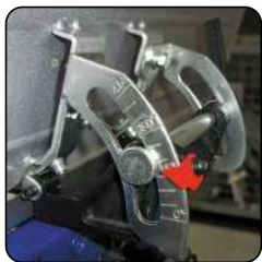
Geleider in aluminium profiel, kan tot 45° hellen
