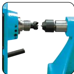
Meenemerstift met schroefdraad M33 x 3,5 mm
