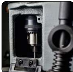
Boorkopsysteem voor bevestiging van de boor
