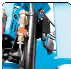
Afdaling van de boeg door hydraulische cilinder met regelbaar debiet
