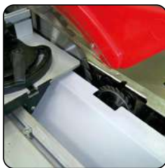
Zaagblad ø 315 of ø 250, voorritsblad van ø 100 mm
