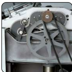
Kettingaandrijving. Motoraandrijving met dubbele riem
