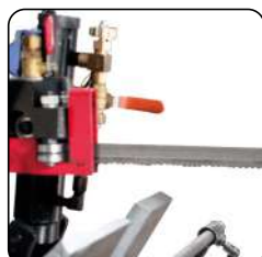
Aanpasbare en zeer nauwkeurige geleiding van het zaagblad met 8 punten rollen
