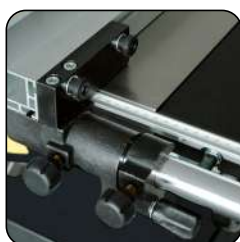
Geleider voor doorzagen in de lengte met micrometer afstelling
