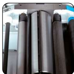
Aandrijvingsrollen voor de aanvoer van het stuk hout
