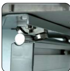
Slede voor plugboren met glijdsysteem op kogellagers
