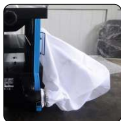
Ingebouwd afzuigstelsysteem (met opvangzak)
