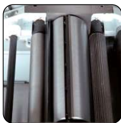
Schaafspindel van \varnothing 70 mm met 3 messen 310 x 25 x 3
