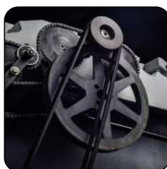
Kettingaandrijving. Motoraandrijving met dubbele riem
